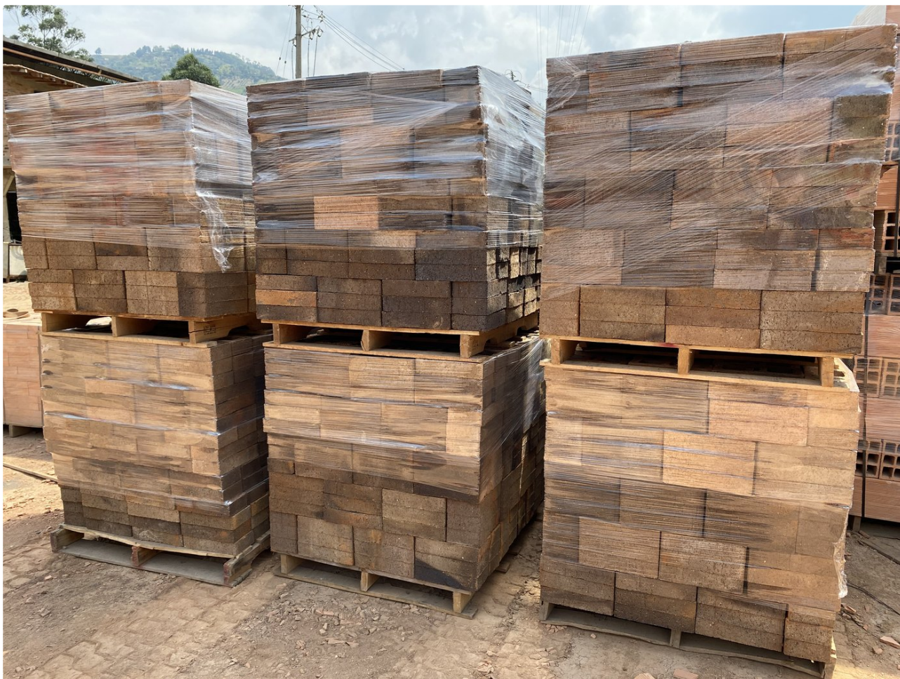
Almacenamiento correcto en planta Clayhouse — estibas con cubierta plástica protectora, sobre madera, lejos del piso. Esta es la versión real del esquema superior.
